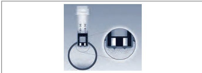
Bild 1: Funktionsprinzip des Durchfluss-Sensors
